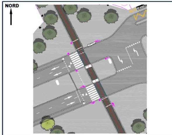
Figure 18 : Carrefour de place Bougainville - aménagement post travaux tramway (source : MOE Tramway NS) L'écoulement des flux sera régulé par deux phases de feux sur un cycle de 90 secondes :
