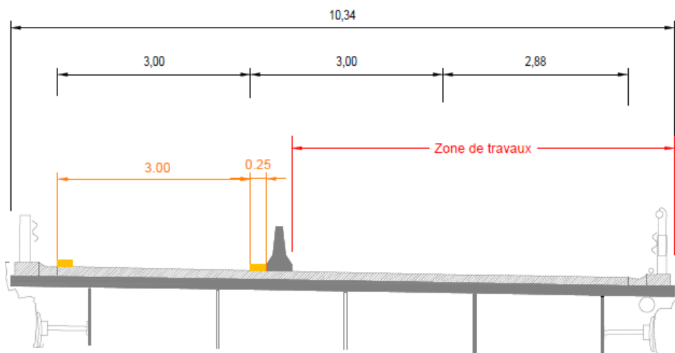
Figure 7 : Profil en travers sur ouvrage, phase 2
